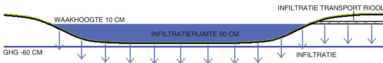
Figuur 33: Doorsnede infiltratieveld Lieropsedijk 28
