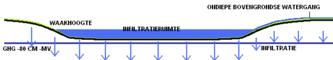
Figuur 32: Doorsnede infiltratievelden
