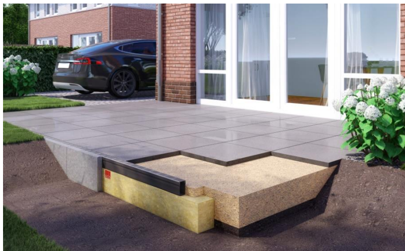
Figuur 17 Referentiebeelden Rockflow onder oppervlak ( www.nbd-online.nl )
