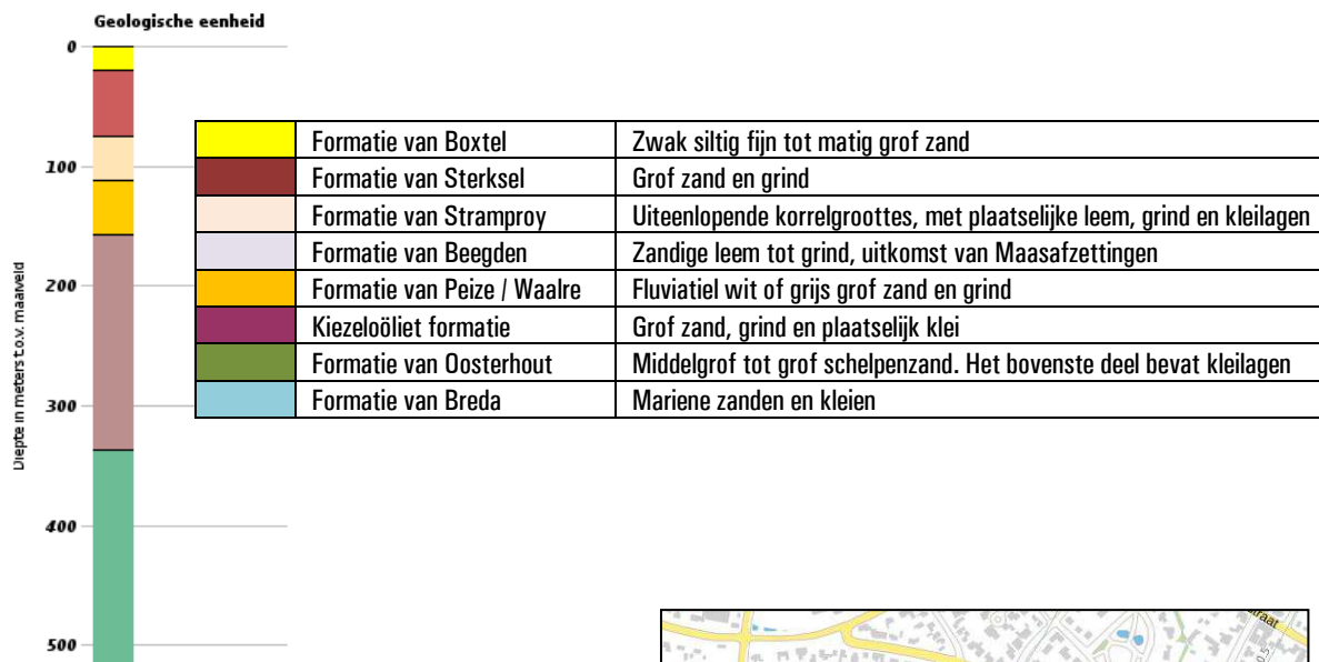
Figuur A: opbouw ondergrond.
