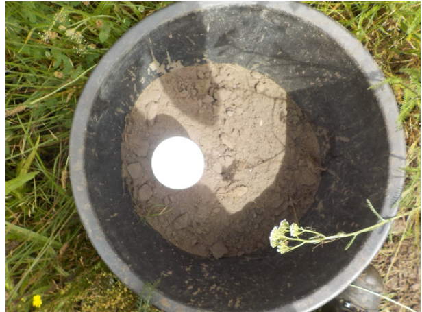
Foto 10. Uitgegraven materiaal proefgat 11
