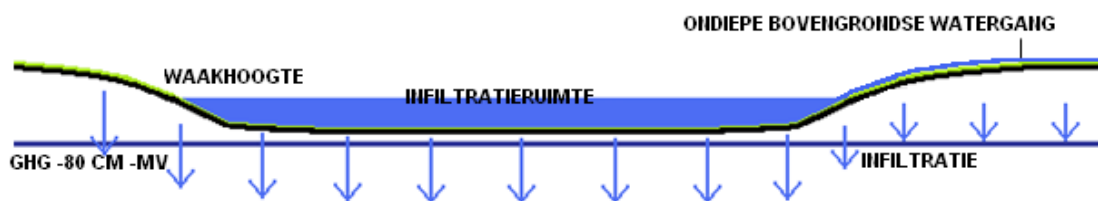
Figuur 32: Doorsnede infiltratievelden
