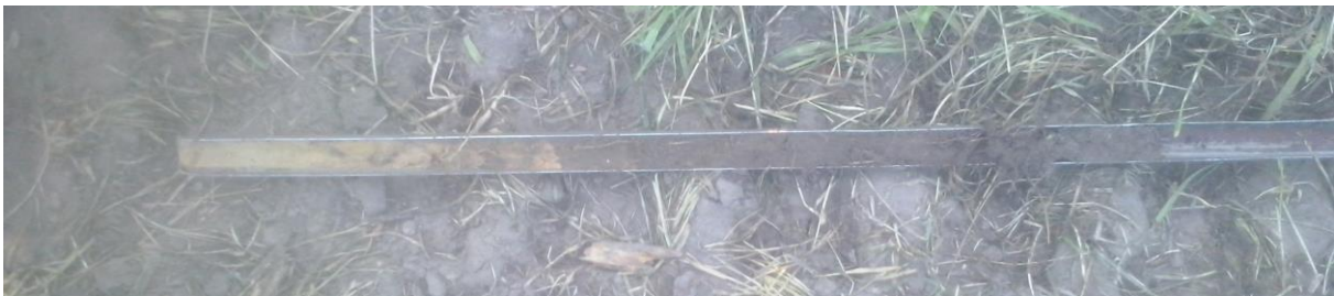
Figuur 16: Het pakket van brokken zand van uiteenlopend humusgehalte (rechts), zoals dat op alle boorpunten is aangetroffen.
