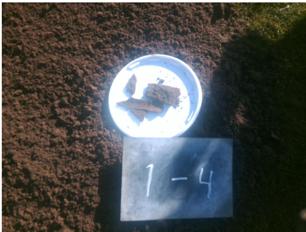
Foto 7. Asbestverdacht materiaal sleuf 1-04
