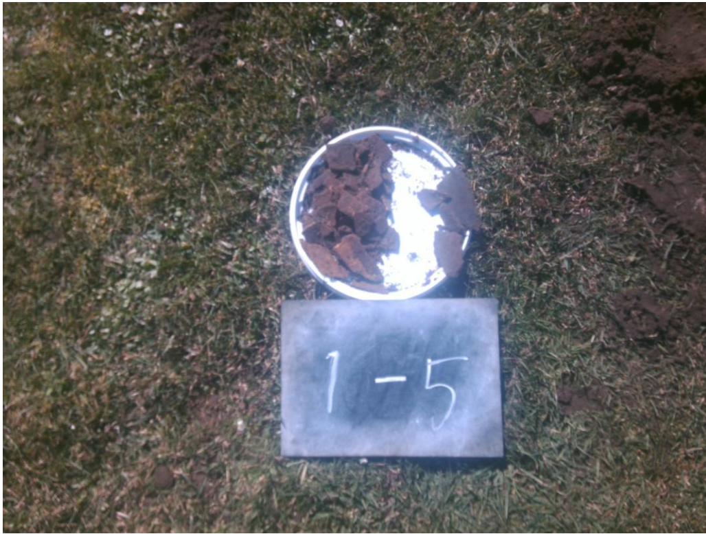
Foto 9. Asbestverdacht materiaal sleuf 1-05
