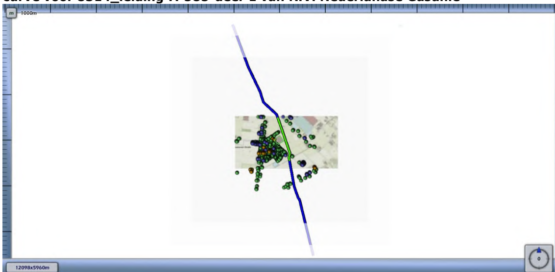
Figuur 4.2 Kilometer leiding behorende bij de maximale overschrijding van de FN-curve voor 8314_leiding-A-585-deel-1 van N.V. Nederlandse Gasunie
