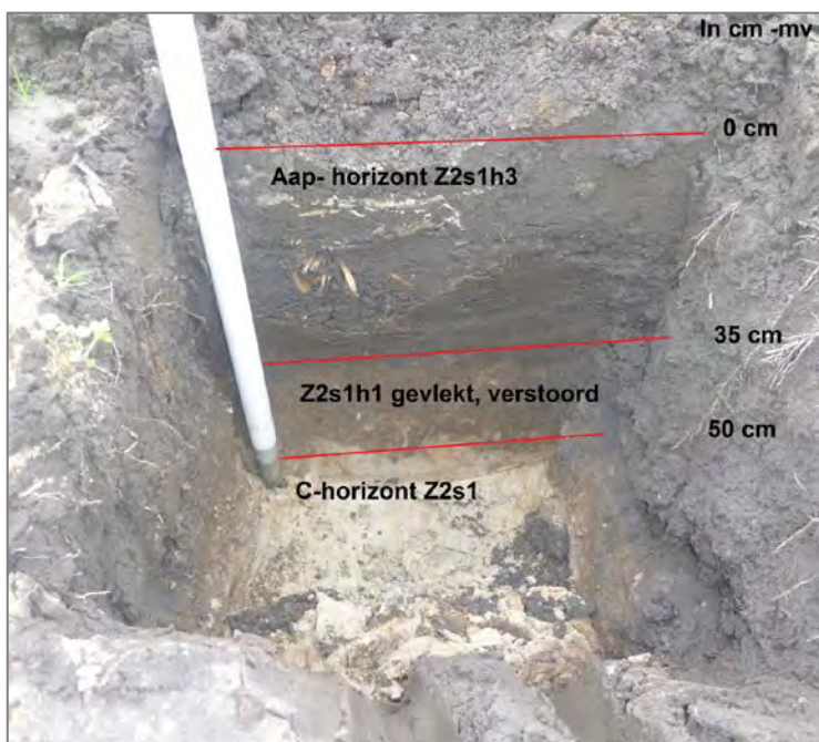
Fig. 3.2: Bodemopbouw in profielputje ter hoogte van boring 3.
