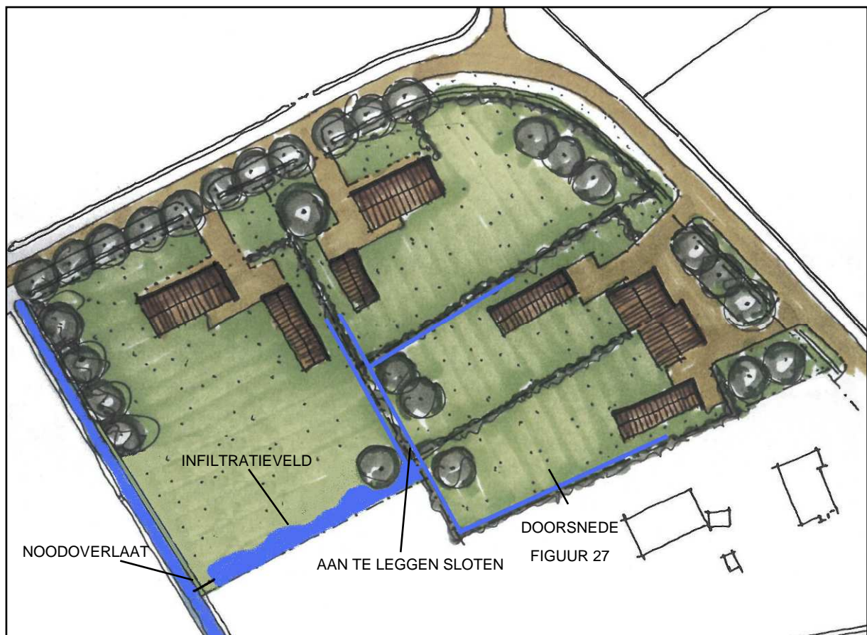
Figuur 26: Hemelwaterafvoer Kouterstraat 1
